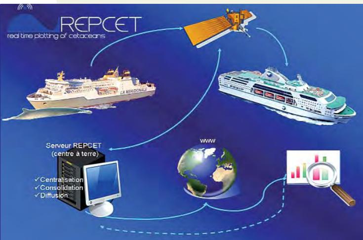
**Le navire observant un cétacé transmet l'information à un serveur situé à terre, en temps réel via un satellite.**
