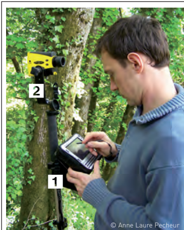
1. Ordinateur de terrain avec le logiciel Field-map . 2. Trupulse (boussole, télémètre et clinomètre).
