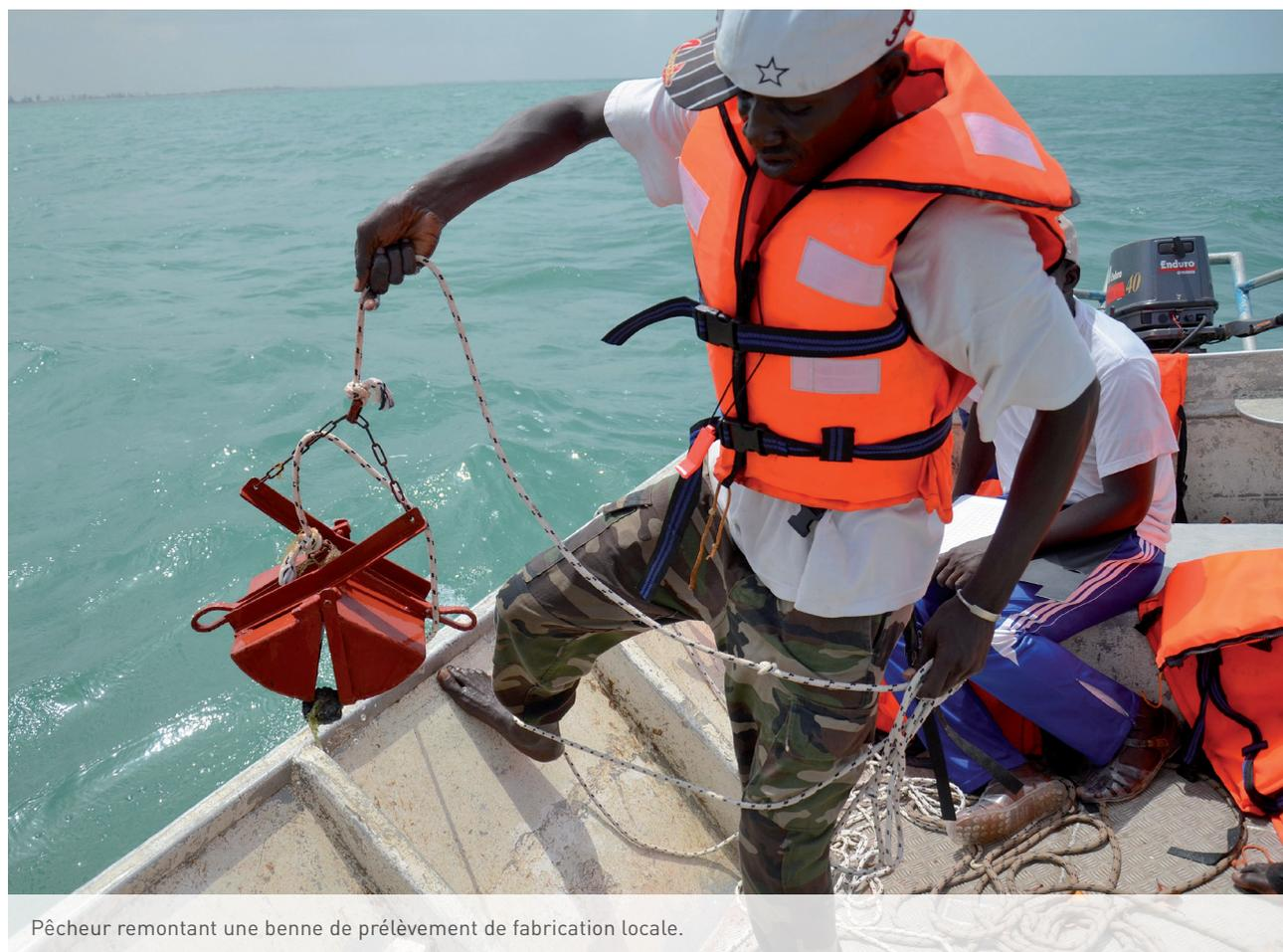
Pêcheur remontant une benne de prélèvement de fabrication locale.
