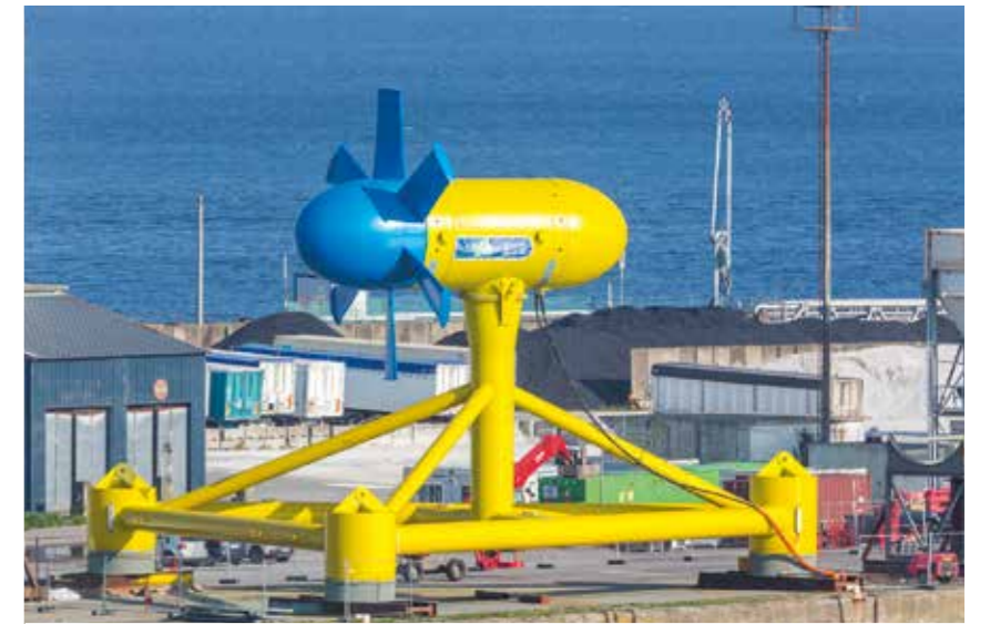
Hydrolienne dans le PNM d'Iroise.
